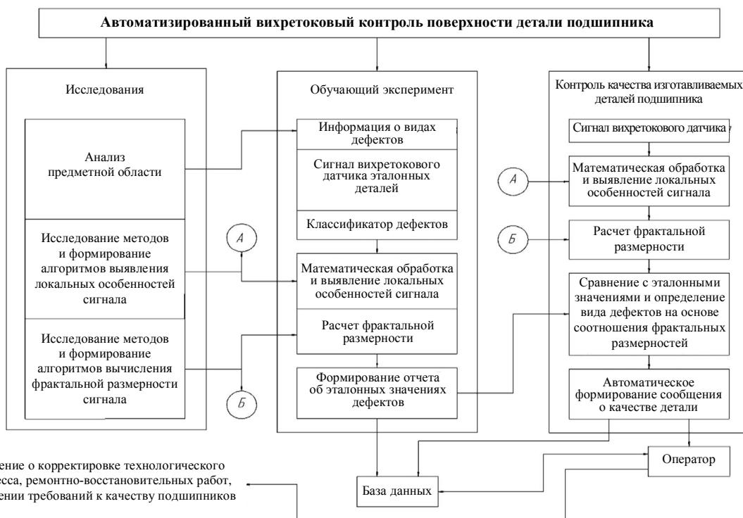
Рис. 4. Методическое обеспечение автоматизированной системы принятия решения о качестве подшипников на основе вихревокового контроля
