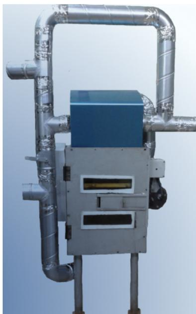
Рис. 3. Малогабаритная сушильная установка
