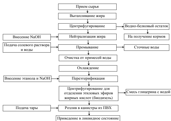
Рис. 5. Модель технологии биотоплива из жиросодержащих отходов гидробионтов
