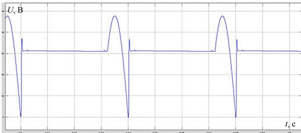
Рис. 4. Форма выходного напряжения полупроводящего однофазного преобразователя
