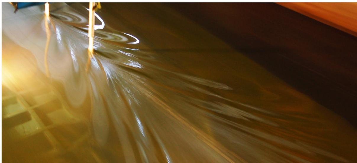
Рис. 10. Фотоизображение волновой картины у двух движущихся последовательно стоек тупым концом каплевидного поперечного сечения вперёд
