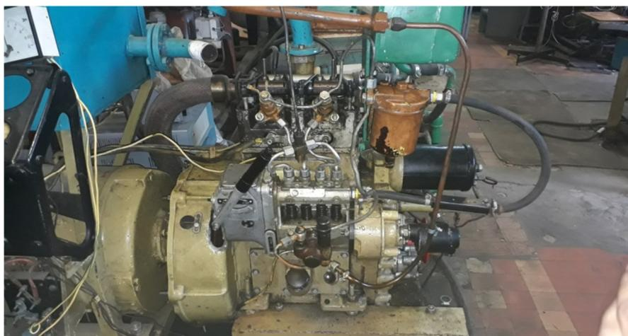
Рис. 8. Вид двигателя с магнетизёром
