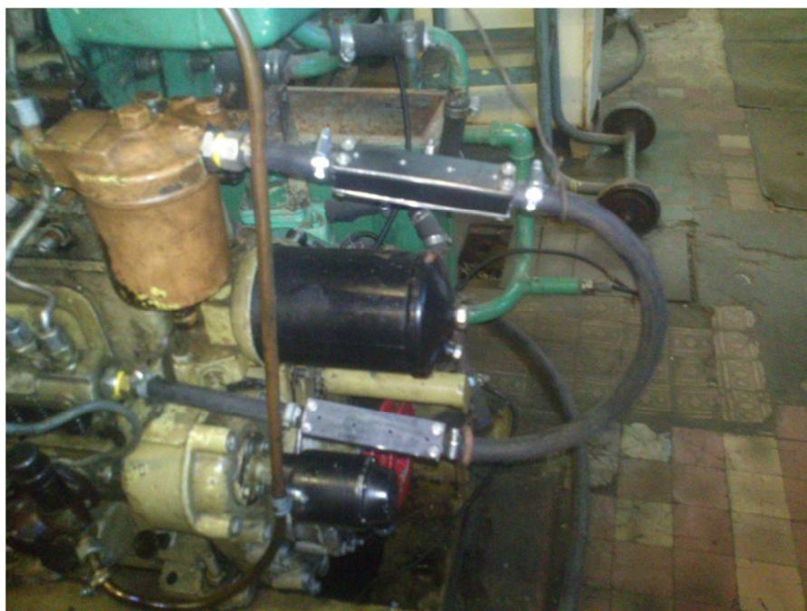
Рис. 9. Вид двигателя с двумя магнетизёрами
