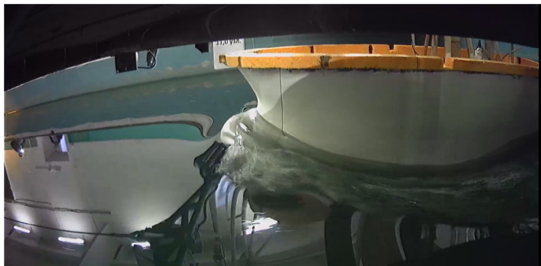
Рис. 6. Вид сбоку в 3-м случае нагрузки. Скорость – 11 уз ( Fr = 0,36 )
