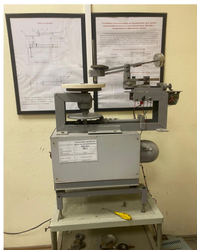
Рис. 1. Установка для испытаний трением по монолитному абразиву
