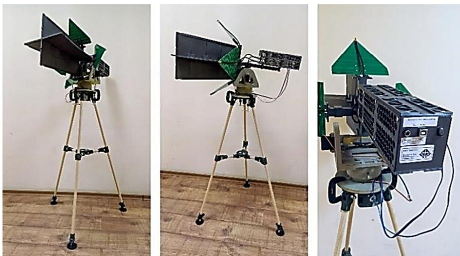
Рис. 10. Лабораторный макет радиолокационной системы электромагнитного мониторинга
