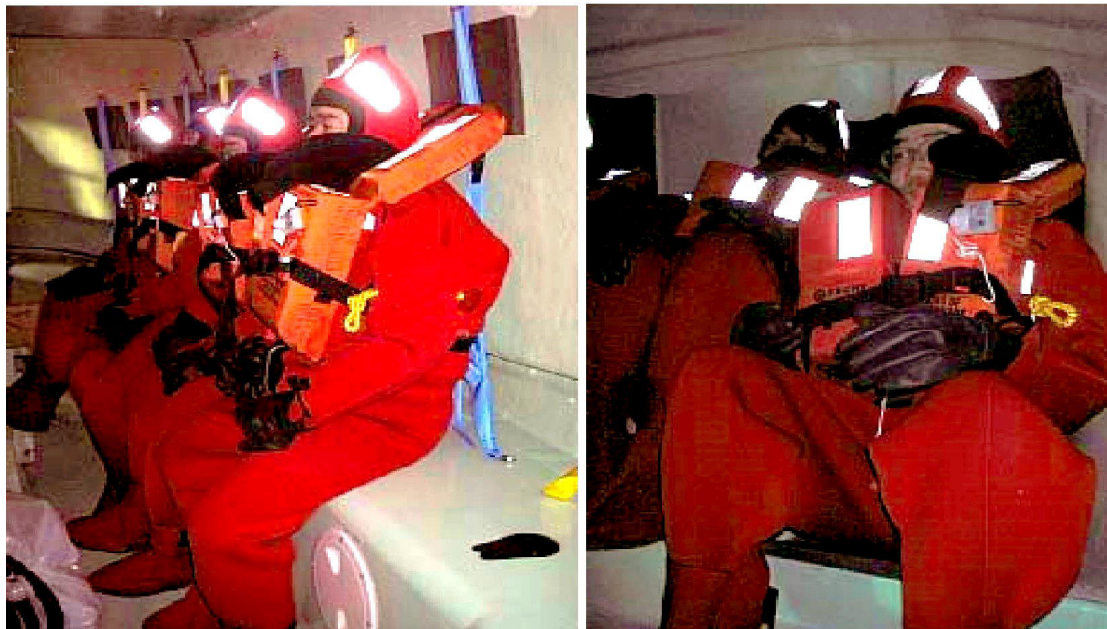
Рис. 5. Размещение людей в салоне закрытой спасательной шлюпки: а – позы людей в начальный период после посадки; б – через 20 мин ощущается неудобство жесткого спасательного жилета
