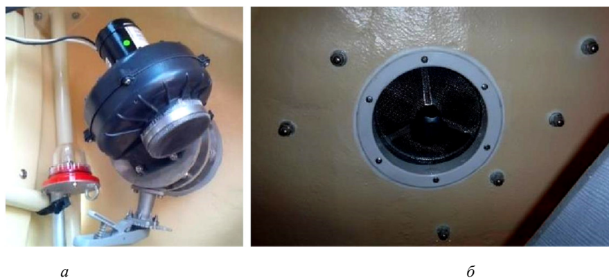
Рис. 8. Оборудование вентиляции внутри шлюпки: а – напорный вентилятор; б – закрытие воздуховода
