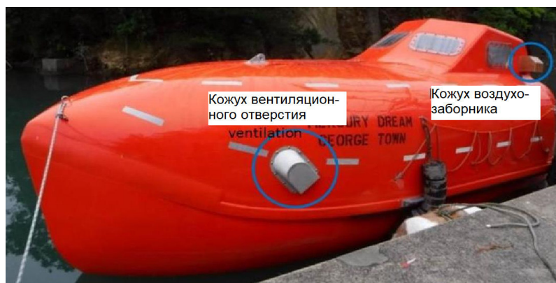
Рис. 7. Установка оборудования для проведения испытаний по эффективности вентиляции в полностью закрытой спасательной шлюпке
