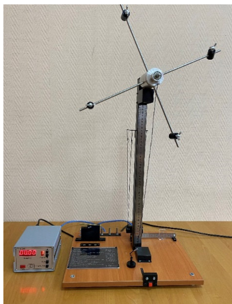
Рис. 2. Модульный учебный комплекс для изучения законов вращательного движения
