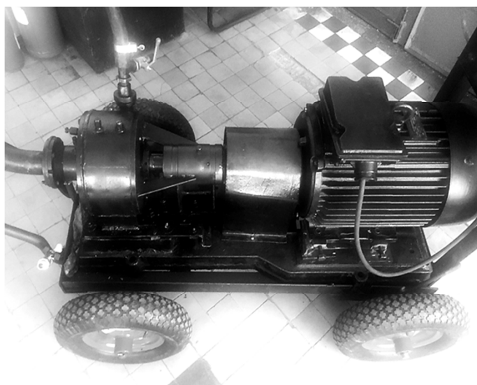
Рис. 1. Лабораторная установка для производства газообразного компонента с водородом из дизельного топлива
