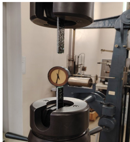
Рис. 6. Испытания образцов на растяжение
