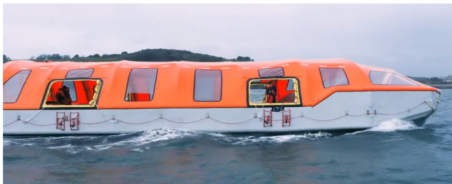
Рис. 5. Спасательная шлюпка из пневмопанелей вместимостью 530 человек
