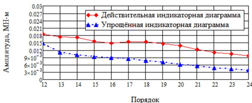
Рис. 2. Амплитуды гармонических составляющих крутящего момента от сил давления газов 12–24-го порядков
