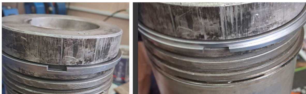
Рис. 7. Расположение «замков» поршневых колец относительно друг друга: a – положение поршня, при котором тепловой зазор поршневого кольца находится сверху; б – положение поршня, при котором тепловой зазор поршневого кольца находится снизу
