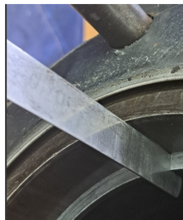
Рис. 8. Контроль величины теплового зазора поршневого кольца при помощи щупа
