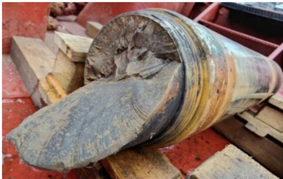
Рис. 1. Излом гребного вала речного судна
