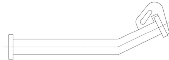
Рис. 11. Приспособление для прихватки фланцев и колец под угол 90 град
