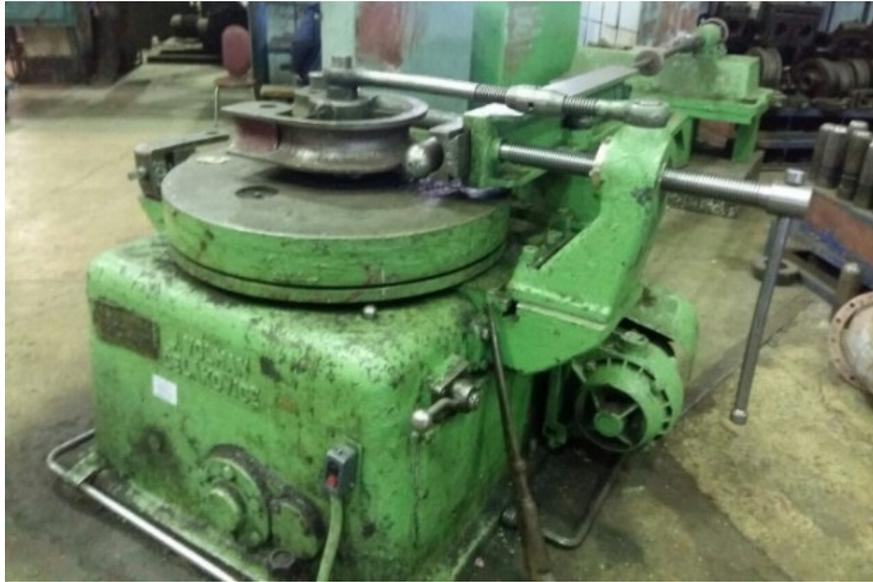
Рис. 4. Трубогибочный станок
