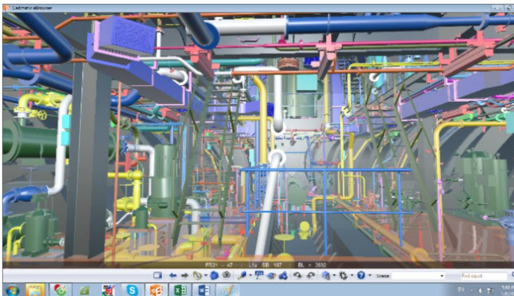
Рис. 12. Трехмерное моделирование трубопроводов судовых систем
