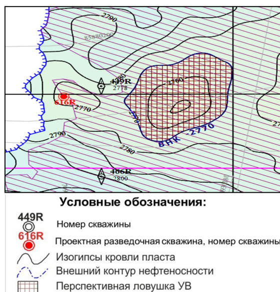
Рис. 3. Перспективная ловушка углеводородов (УВ) Ач 1-2 [2]
