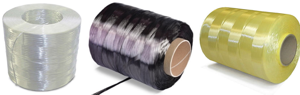
Рис. 3. Внешний вид укрепляющих волокон: стекловолокно, углеродное волокно (карбон) и арамидное волокно
