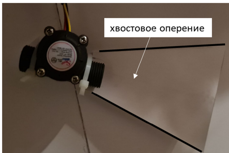
Рис. 1. Собранный датчик для измерения скоростей течения в открытом русле
