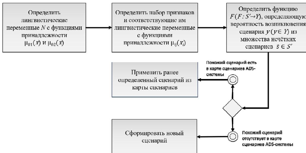
Модель процесса формирования каталога сценариев для проведения испытаний высокоавтоматизированных транспортных средств и ADS-систем с целью анализа и оценки их функциональной безопасности
