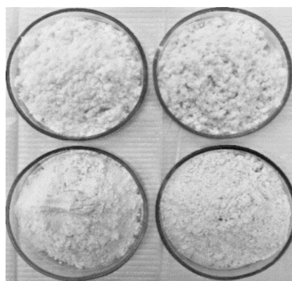
Рис. 3. Фото фракций рыбьей чешуи (слева направо) судака ( Sander lucioperca ), пресноводного леща ( Abramis brama ): верхний ряд – обогащенных органическими компонентами с размером частиц 0,05 мм и более; нижний ряд – обогащенных неорганическими компонентами с размером части 0,05 мм и менее
