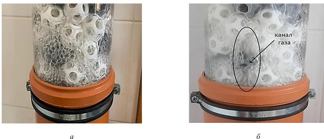
Рис. 2. Гидродинамические режимы в экспериментальной колонне: а – режим устойчивой работы колонны с барботажем газовых пузырей; б – режим неустойчивой работы колонны с каналобразованием
