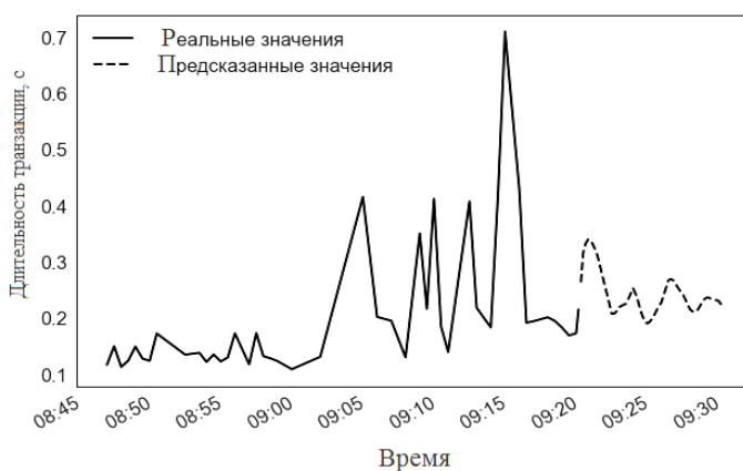
Рис. 11. Прогнозирование длительности транзакций TCP линейной регрессией
