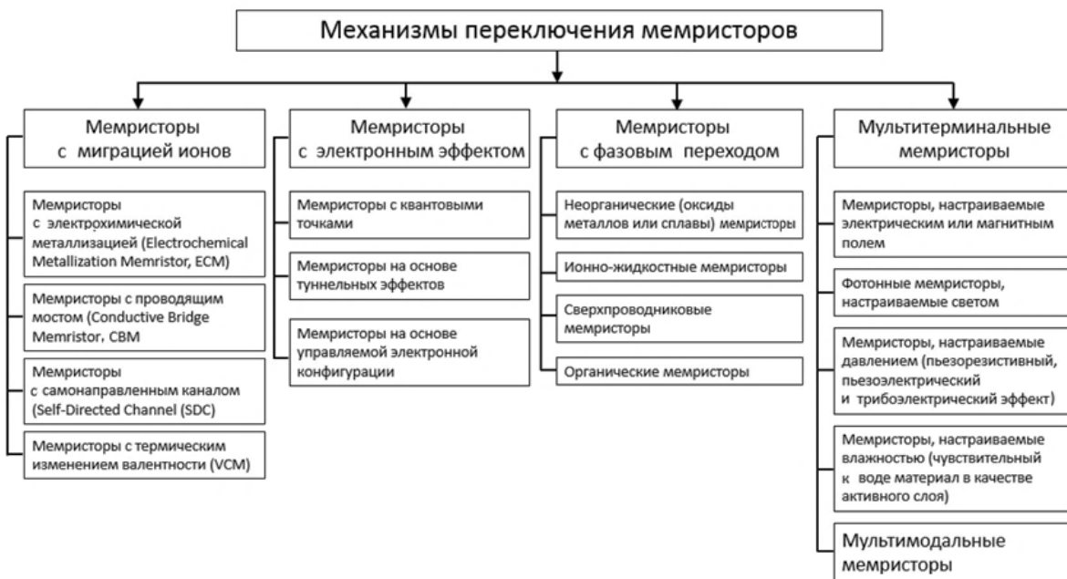
Рис. 5. Классификация мемристоров, используемых в биосенсорике
