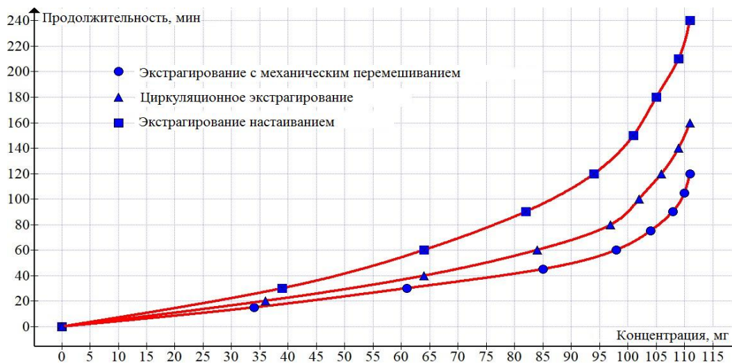
Рис. 3. Кривые экстрагирования (обратная зависимость)
