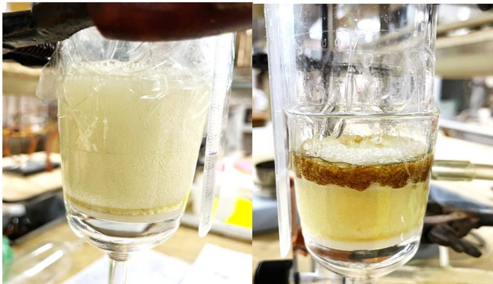
Рис. 8. Осаждение пены при добавлении ингибитора коррозии «Додиген» в раствор МДЭА
