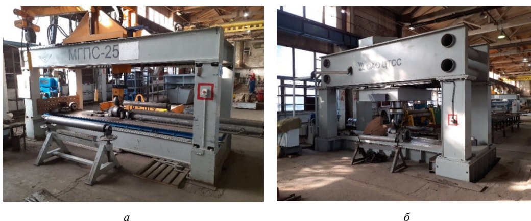
Рис. 2. Многофункциональные гибочно-правильные станки типа МГПС-25 ( а ) и МГПС-100 ( б ) разработки АО «ЦТСС», внедренные на филиале «Астраханский судоремонтный завод» АО «ЦС «Звездочка»
