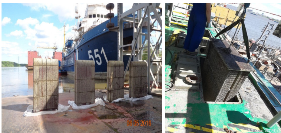
Рис. 11. Боксулеры до и после очистки во время докования судна (2016, 2021 гг.)
