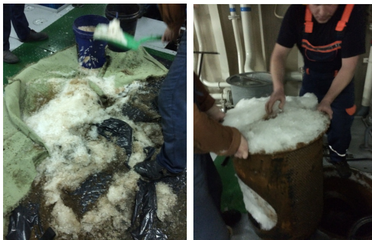
Рис. 14. Ручная очистка приемных ящиков и применение ловушек на судне «Сталинград»
