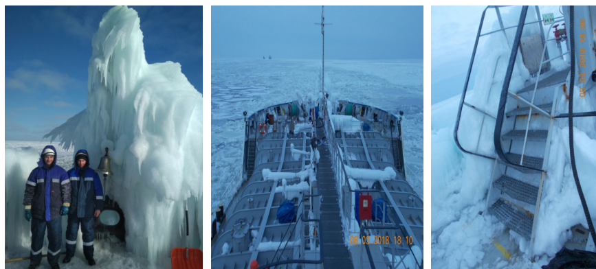
Рис. 13. Обледенение судна «Балт Флот 15» в Балтийском море (январь 2018 г.)
