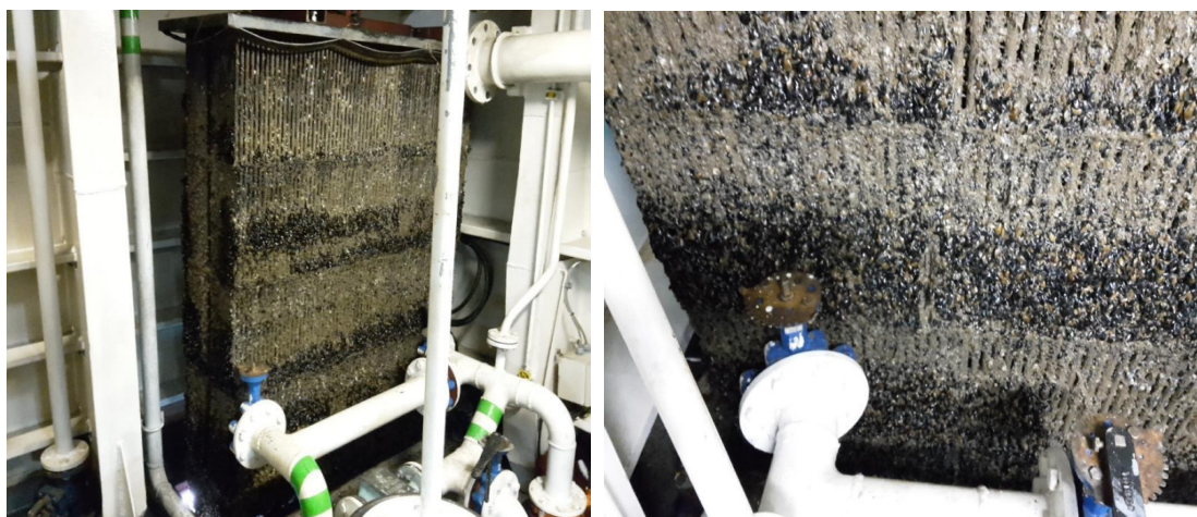
Рис. 9. Состояние бокскулера теплохода «Петробалк 1» за период работы в Азовском и Черном морях (август 2020 г.)
