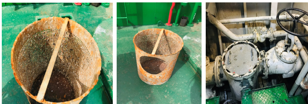
Рис. 4. Износ кингстонных ловушек теплохода «ВТС-1» (март 2020 г.)
