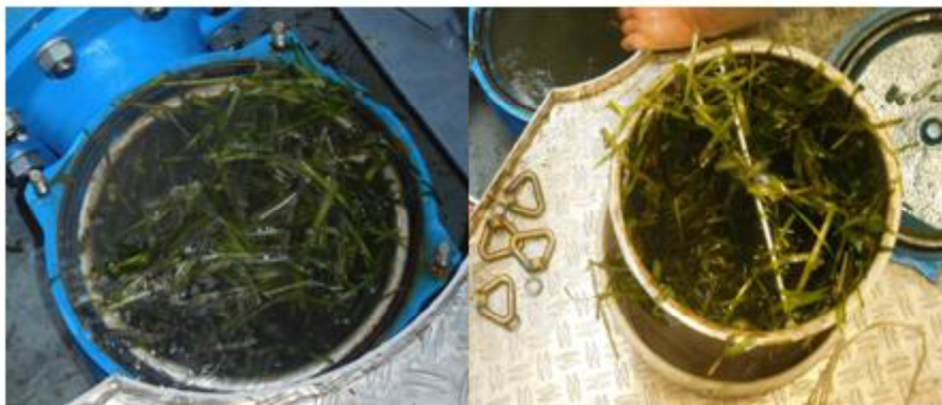
Рис. 6. Состояние фильтрующих ловушек землесоса «Петр Саблин» (август 2016 г.)
