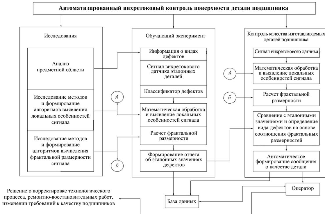
Рис. 4. Методическое обеспечение автоматизированной системы принятия решения о качестве подшипников на основе вихретокового контроля
