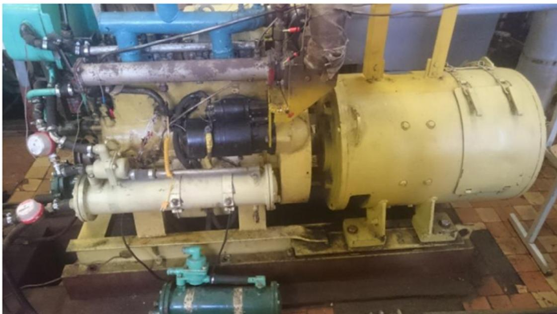
Рис. 4. Дизель 4Ч9,5/11 с системой газотурбинного наддува посредством турбокомпрессора ТКР 6 (4ЧН9,5/11)
