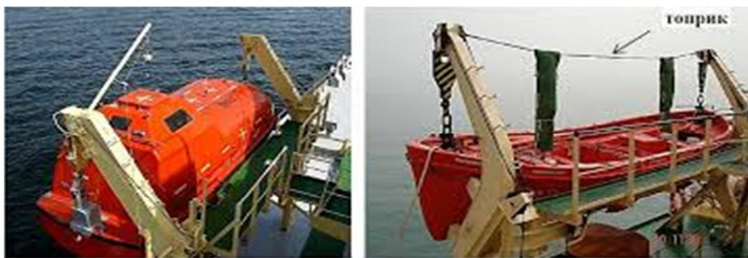
Рис. 1. Шлюпки закрытого и открытого типов на шлюпбалочных таях
