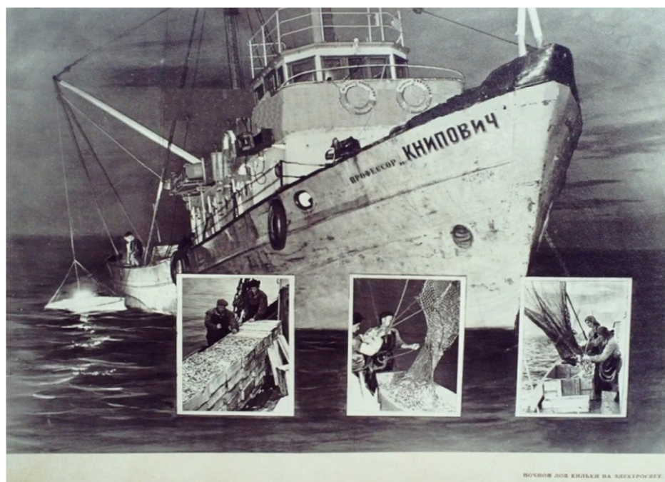
Рис. 2. Лов кильки на электросвет с помощью конусного подхвата
