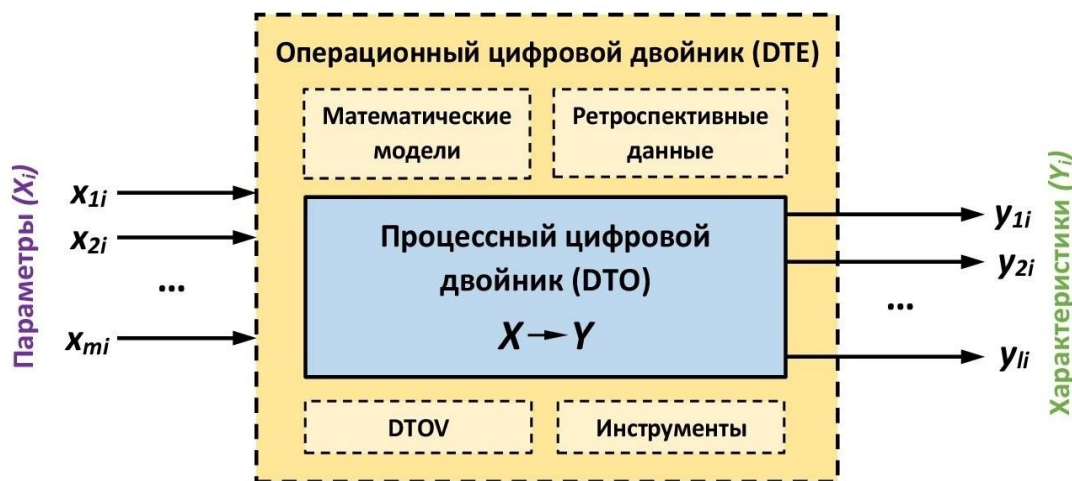
Рис. 4. Процессный эксплуатационный цифровой двойник судна
