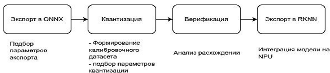
Рис. 1. Схема экспорта модели YOLO
