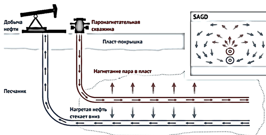
Рис. 3. Метод парогравитационного дренирования с применением растворителей
