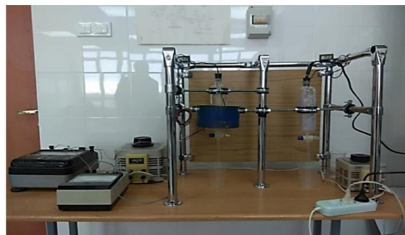
Рис. 1. Общий вид лабораторной электромагнитной деэмульсационной установки
