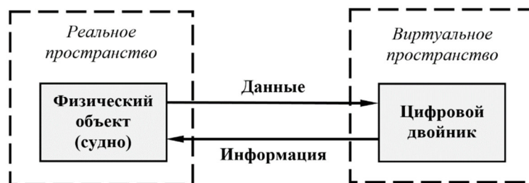
Рис. 1. Простейшая визуализация концепции цифрового двойника (основные части цифрового двойника)
