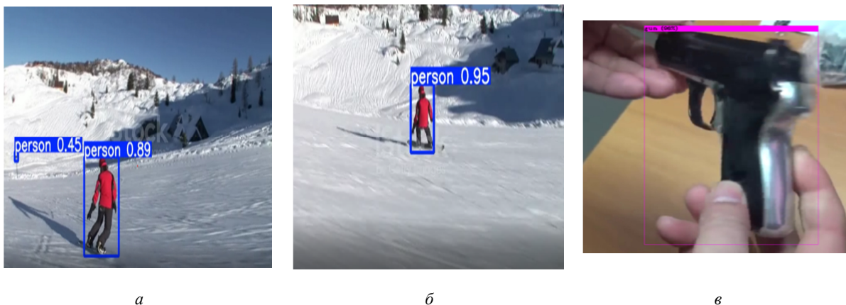
Рис. 5. Результаты тестирования обученной модели нейронной сети архитектуры YOLOv5: а – исходный набор данных (model 1); б – удвоенный набор данных (model 2); в – распознавание нового объекта
