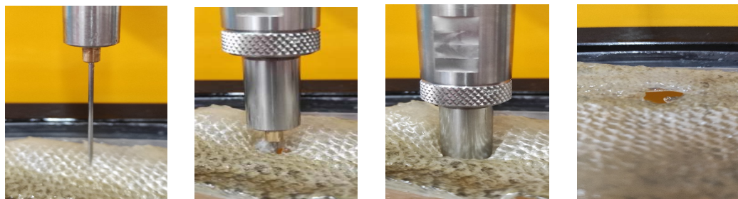
Рис. 9. Разрыв ткани в момент пиковой нагрузки всей площадью зонда в конце гидролиза на приборе Brookfield CT3 Texture Analyzer (справа)
