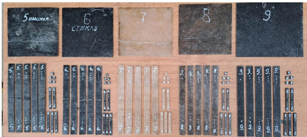
Рис. 4. Подготовка образцов к испытаниям
