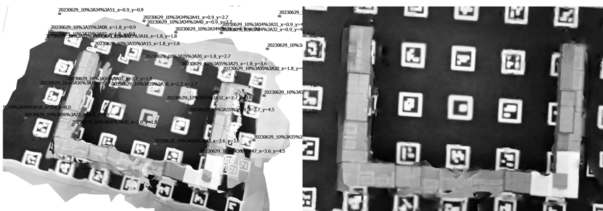
Рис. 10. Трехмерная модель полигона для построения модели причалов морского пассажирского порта
