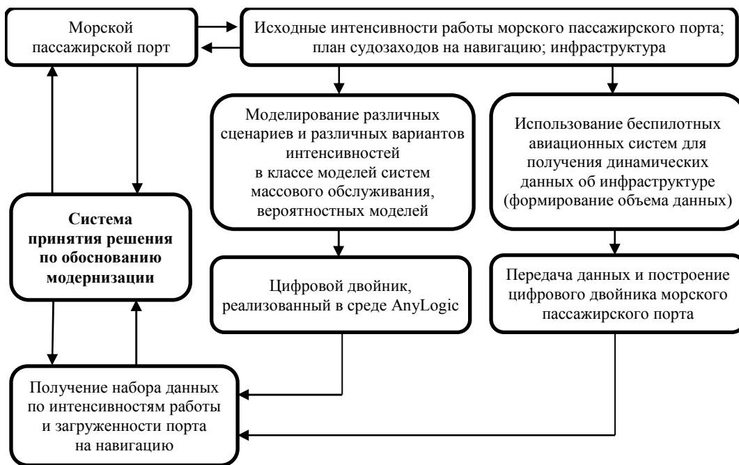
Рис. 5. Модель работы с цифровым двойником морского пассажирского порта и включением данных от беспилотных авиационных систем
