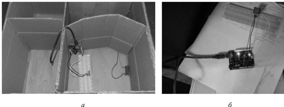
Рис. 7. Процесс измерения и поддержания заданной температуры с помощью датчика DHT11 и платы Arduino UNO:
