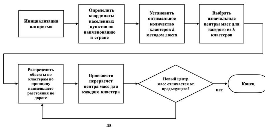
Рис. 8. Блок-схема алгоритма нахождения оптимального расположения распределительных центров для доставки заказов
