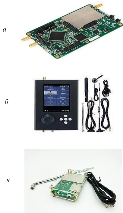
Рис. 9. Применяемые SDR-платформы: а – SDR HackRF One; б – PortaPack; в – SDR Play
