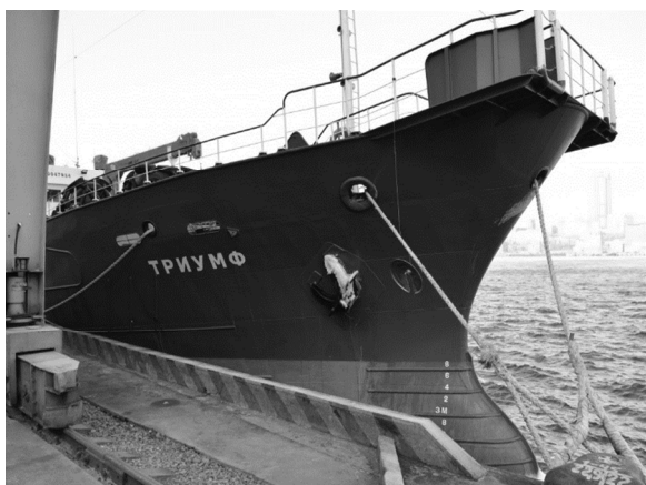
Рис. 5. Ярусное судно «Триумф» (Япония, 1992 г.): длина – 51,3 м; ширина – 9,1 м; высота борта – 3,9 м; водоизмещение – 1 098 т; мощность главного двигателя – 1 103 кВт; главная энергетическая установка: главный двигатель + реверс-редуктор + винт фиксированного шага
