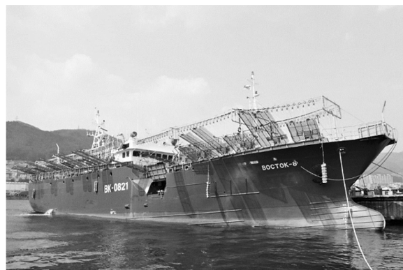
Рис. 13. Ярусное судно «Восток-8» (Япония, 2004 г.): длина – 56,77 м; ширина – 9,0 м; высота борта – 3,9 м; водоизмещение – 1 020 т; мощность главного двигателя – 810 кВт; главная энергетическая установка: главный двигатель + реверс-редуктор + винт регулируемого шага
