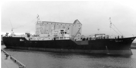
Рис. 9. Ярусное судно «Восток-4» (Япония, 1989 г.): длина – 49,56 м; ширина – 8,7 м; высота борта – 6,20 м; водоизмещение – 699 т; мощность главного двигателя – 698 кВт; главная энергетическая установка: главный двигатель + мультипликатор + реверс-редуктор + винт регулируемого шага
