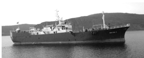
Рис. 10. Ярусное судно «Восток-5» (Япония, 1988 г.): длина – 43,75 м; ширина – 8,30 м; высота борта – 3,60 м; водоизмещение – 607 т; мощность главного двигателя – 699 кВт; главная энергетическая установка: главный двигатель + мультипликатор + реверс-редуктор + валогенератор + винт регулируемого шага
