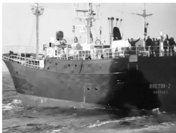
Рис. 7. Ярусное судно «Восток-2» (Япония, 1987 г.): длина – 37,02 м; ширина – 7,5 м; высота борта – 3,15 м; водоизмещение – 431 т; мощность главного двигателя – 618 кВт; главная энергетическая установка: главный двигатель + реверс-редуктор + валогенератор + винт регулируемого шага
