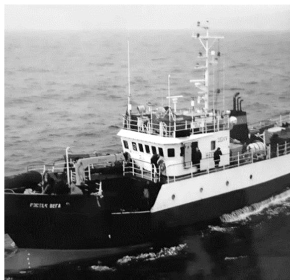
Рис. 3. Малое ярусное морозильное судно «Восток Вега» (Южная Корея, 1995 г.): длина – 30,9 м; ширина – 6,9 м; высота борта – 2,67 м; водоизмещение – 218 т; мощность главного двигателя – 430 кВт; главная энергетическая установка: главный двигатель + реверс-редуктор + винт фиксированного шага
