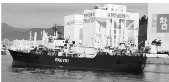
Рис. 11. Ярусное судно «Восток-6» (Япония, 1991 г.): длина – 49,10 м; ширина – 8,80 м; высота борта – 3,80 м; водоизмещение – 720 т; мощность главного двигателя – 699 кВт; главная энергетическая установка: главный двигатель + реверс-редуктор + винт регулируемого шага
