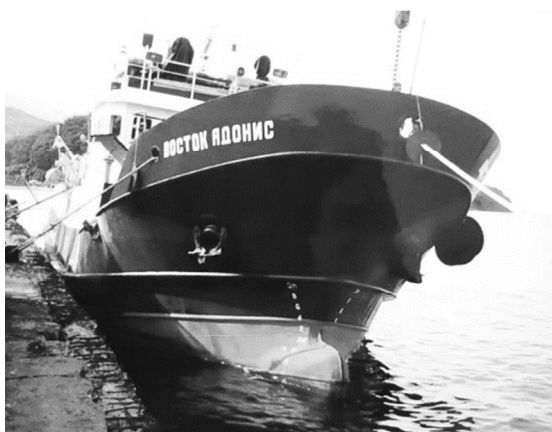
Рис. 2. Малое ярусное морозильное судно «Восток Адонис» (Южная Корея, 1995 г.): длина – 30,9 м; ширина – 6,9 м; высота борта – 2,65 м; водоизмещение – 217 т; мощность главного двигателя – 430 кВт; главная энергетическая установка: главный двигатель + реверс-редуктор + винт фиксированного шага
