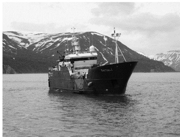
Рис. 6. Ярусное судно «Восток-1» (Испания, 1997 г.): длина – 41,5 м; ширина – 9,5 м; высота борта – 4,6 м; водоизмещение – 716 т; мощность главного двигателя – 780 кВт; главная энергетическая установка: главный двигатель + реверс-редуктор + валогенератор + винт регулируемого шага
