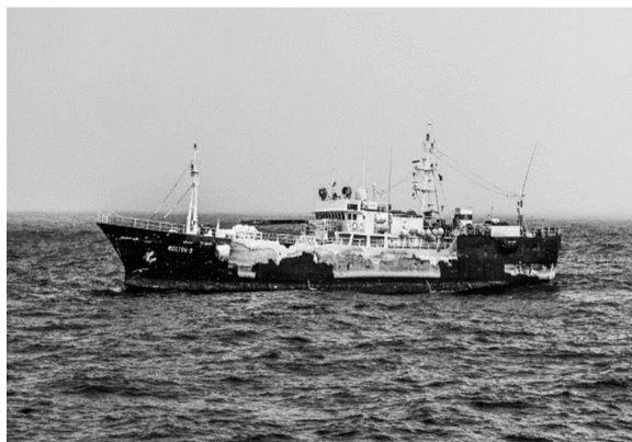
Рис. 8. Ярусное судно «Восток-3» (Япония, 1992 г.): длина – 49,1 м; ширина – 8,8 м; высота борта – 3,8 м; водоизмещение – 703 т; мощность главного двигателя – 950 кВт; главная энергетическая установка: главный двигатель + реверс-редуктор + винт регулируемого шага
