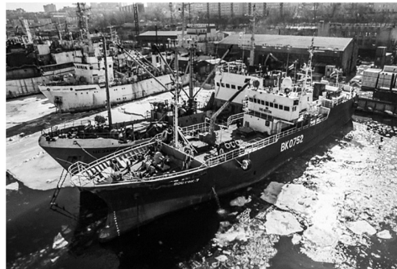
Рис. 12. Ярусное судно «Восток-7» (Япония, 1988 г.): длина – 51,0 м; ширина – 9,0 м; высота борта – 6,2 м; водоизмещение – 820 т; мощность главного двигателя – 735 кВт; главная энергетическая установка: главный двигатель + реверс-редуктор + винт фиксированного шага
