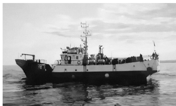
Рис. 4. Малое ярусное морозильное судно «Восток Сириус» (Южная Корея, 1995 г.): длина – 33,73 м; ширина – 6,9 м; высота борта – 2,65 м; водоизмещение – 216 т; мощность главного двигателя – 430 кВт; главная энергетическая установка: главный двигатель + реверс-редуктор + винт фиксированного шага
