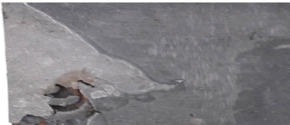
Рис. 3. Образец сварного соединения с наличием коррозионного разрушения
