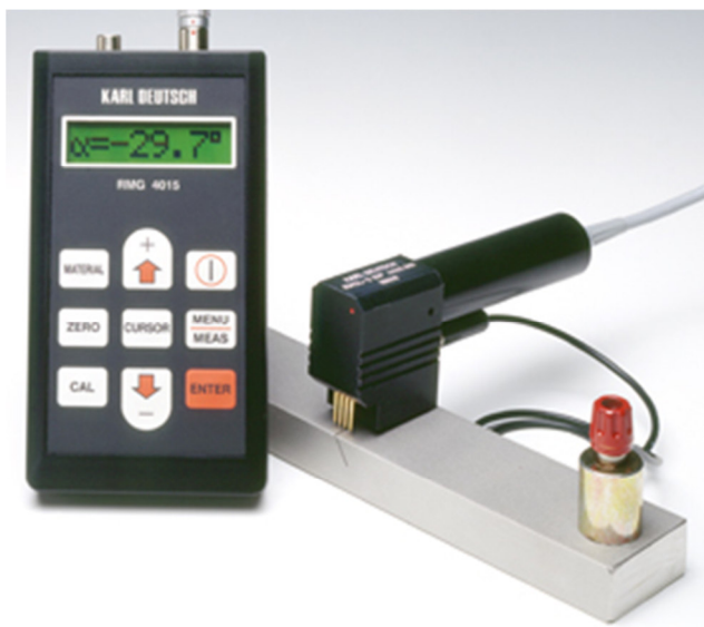
Рис. 1. Измерение наклона трещины по шаблону
