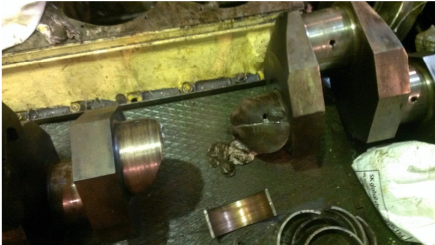
Рис. 3. Усталостное разрушение рамовой шейки КВ
