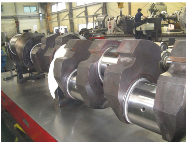
Рис. 5. Восстановленный коленчатый вал дизеля 6ЧН40/46
