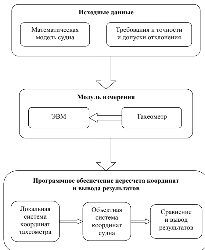
Рис. 6. Блок-схема измерительной системы для судового корпусостроения на основе лазерных тахеометров
