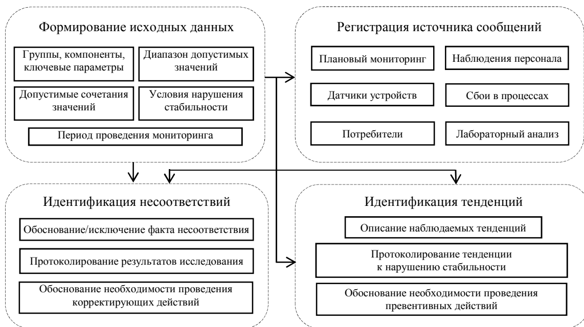
Рис. 2. Структурно-функциональная схема обнаружения и идентификации несоответствий
